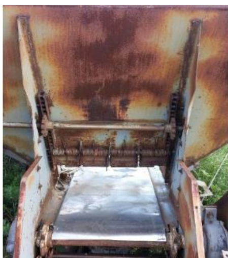
Рисунок 1 - Коррозионные разрушения рабочих поверхностей
