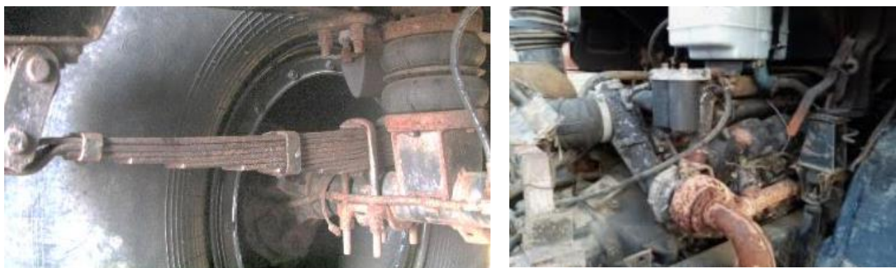
Рисунок 2 - Коррозионные разрушения ходовой части
