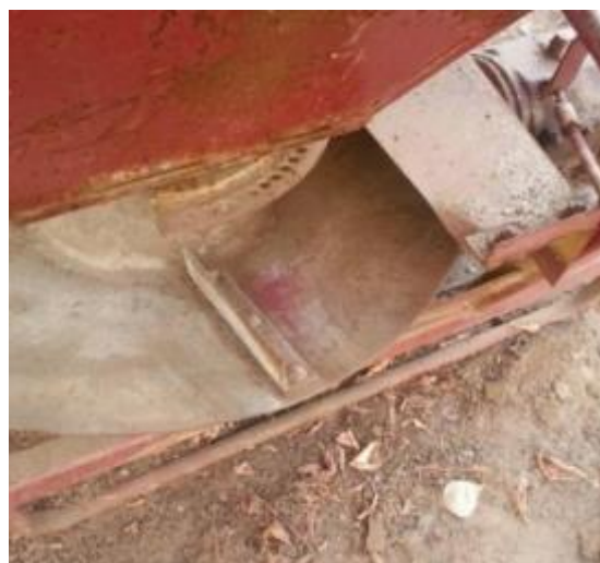
Рисунок 1 - Коррозионные разрушения рабочих поверхностей
