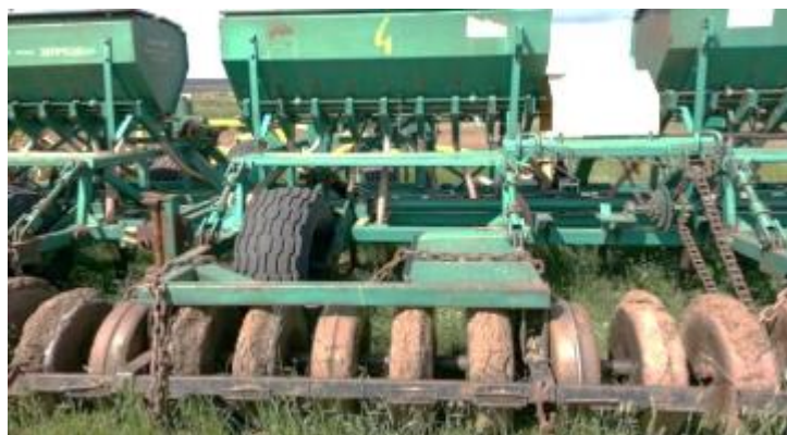
Рисунок 3 – Коррозийные разрушения посевного агрегата АУП-18.05
